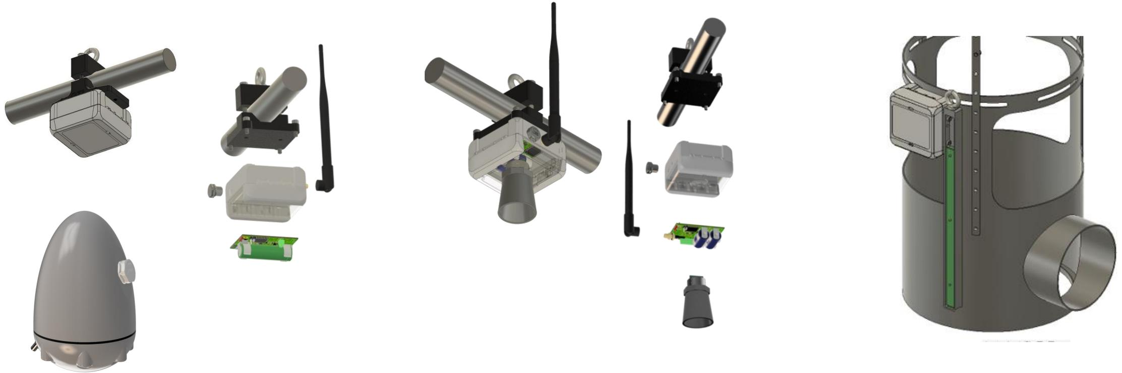
Use Case 1: „Schwimmendes Sensorei“ mit Empfangsstation und Low Power Datentransfer. Mögliche Messung von z.B. Temperatur, Leitfähigkeit, Position
